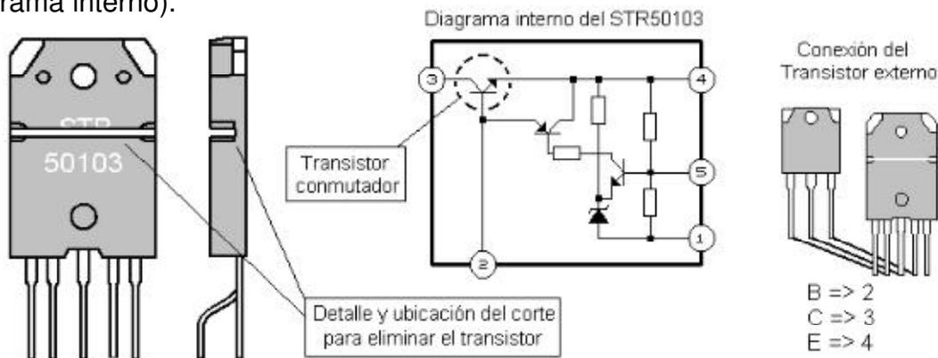
Para aislar o separar dicho transistor defectuoso del resto del integrado, se procede de la siguiente forma: Usando una sierra (o segueta), se realiza un corte en la estructura del integrado, a la altura de las muescas laterales, tal como se muestra en la figura. La profundidad de dicho corte debe llegar hasta la superficie de la placa metálica que sirve de soporte a la construcción del integrado y facilita la disipación de calor (dicha placa está
